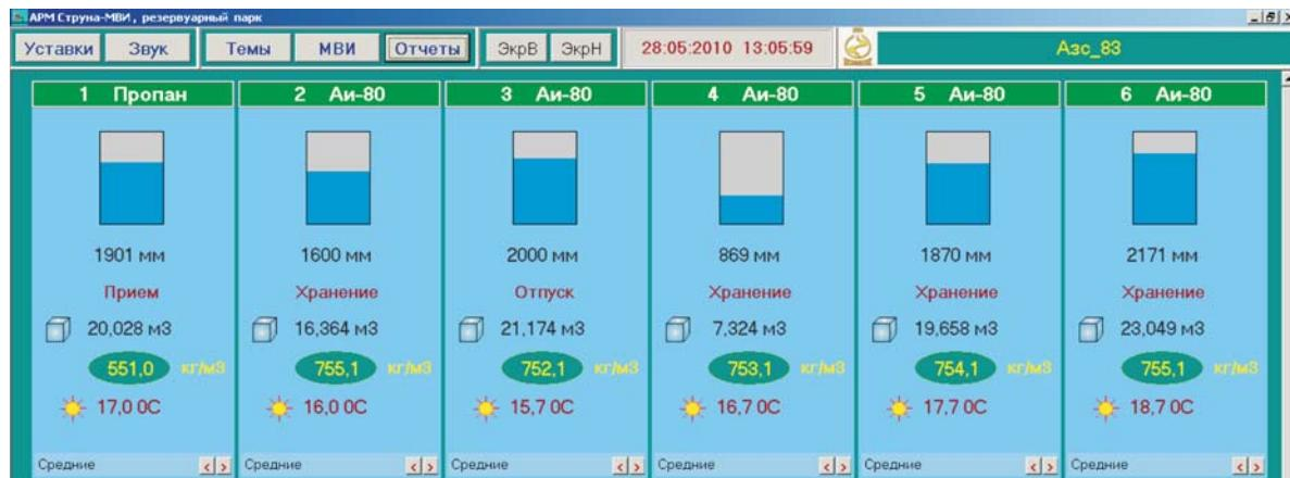
Из удаленного офиса через Интернет можно выбрать и подключиться к нужной АЗС или нефтебазе, просматривать данные по резервуарному парку, производить измерение массы в режиме приёма и отпуска, печатать архивные отчёты.
